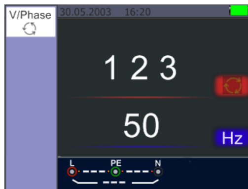
Sequência de fase correcta L1, L2, L3 (campo de rotação no sentido dos ponteiros do relógio)
