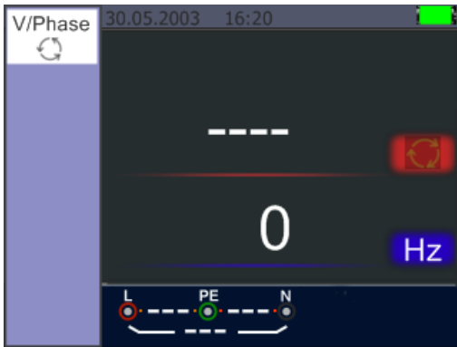
Ecrã inicial da medição da sequência de fases Ligação da medição da sequência de fases
