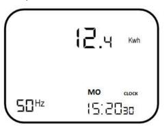
Pulse la tecla MODE para cambiar al rango CO2/kg. Aquí puede comprobar un valor orientativo para los valores de emisión de C02 generado de la potencia medida previamente, el factor de potencia, día de la semana y hora actual. El valor CO2/kg se refiere a un suministro al 100% de potencia suministrada por carbón y se calcula por las emisiones teóricas de CO2 de 0.792 kg/kWh. Si su proveedor de energía le ofrece una mezcla diferente de energía, puede restar ese valor de porcentaje.
