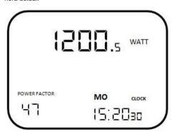
Pulse la tecla MODE para cambiar al rango MÁXIMO de VATIOS (WATT MAX).
