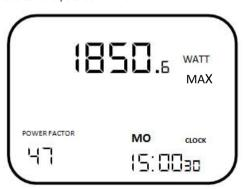
Pulse la tecla MODE para cambiar al rango de kWh (kilovatios hora).
