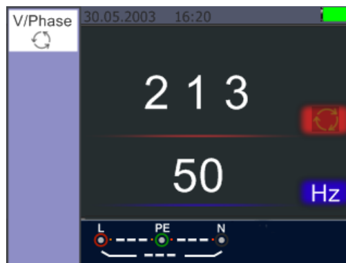
Zwei Phasen vertauscht (linksdrehendes Drehfeld)
