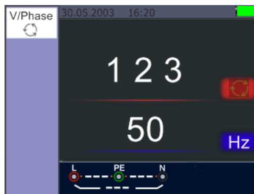
Prawidłowa kolejność faz L1, L2, L3 (pole wirujące w prawo)
