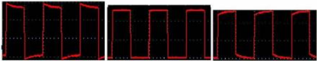
Nadmierna kompensacja Prawidłowo skompensowane Niedobór rekompensat
