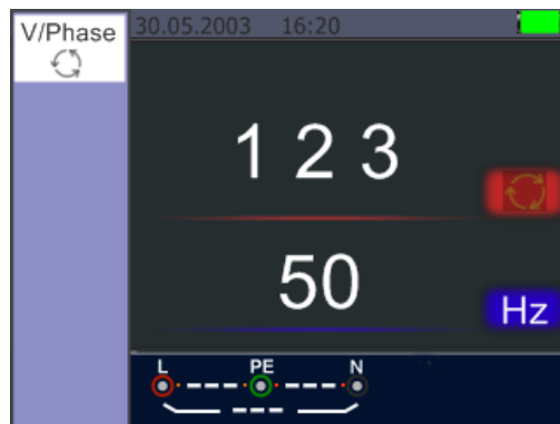
Oikea vaihejärjestys L1, L2, L3 (myötäpäivään pyörivä kenttä).
