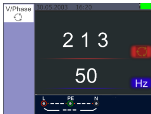
Kaksi vaihetta käännetään (vastapäivään pyörivä kenttä).
