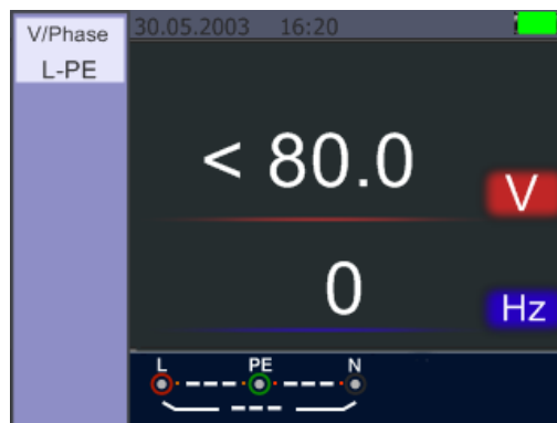
Jännitemittauksen valmiustilanäyttö (< 80V)
