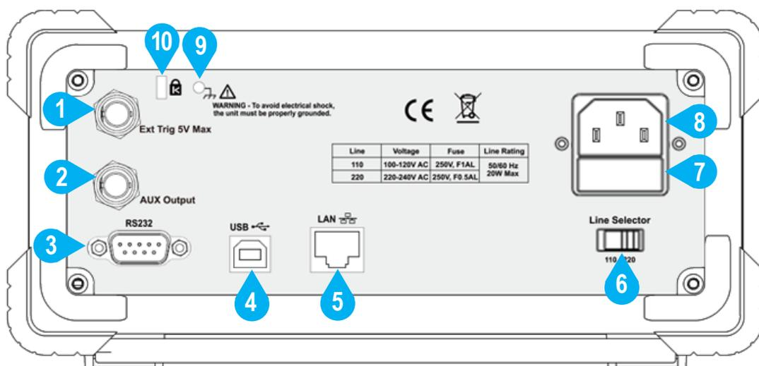
Bild 1-2 Übersicht der Gerätrückseite
