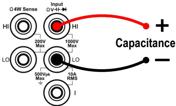
**Tipp:** Schließen Sie die metallischen Anschlusspins jedes Kondensators vor der Prüfung einmal kurz, um diesen zu entladen.
