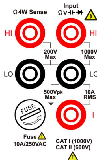
Die vom Benutzer austauschbare 10A Sicherung des Strommessbereichs befindet sich auf der Vorderseite. Um den Schutz zu gewährleisten, ersetzen Sie die Sicherung nur mit Sicherungen der gleichen Bauart und gleichen Nennwerten. Zur angegebenen Bauart und Bewertung der Sicherung siehe auch Seite "7 Stromversorgungsanschlüsse" unter "Frontplattenübersicht" auf Seite 9.
