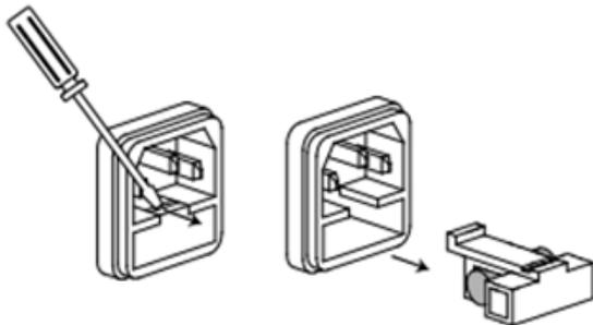
3. Ersetzen Sie die Sicherung durch eine neue, die mit der Spannung übereinstimmen sollte. Installieren Sie es in den Sicherungskasten und schieben Sie den Sicherungskasten wieder auf die Rückwand.
