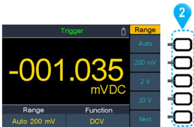
**Automatische Bereichswahl:** Aktivieren Sie die Auto- Funktion über die korrespondierende obere Taste (2) der Softkey-Leiste. Die automatische Bereichswahl wählt den Messbereich abhängig des Eingangswertes, nicht jedoch die Messfunktion.
