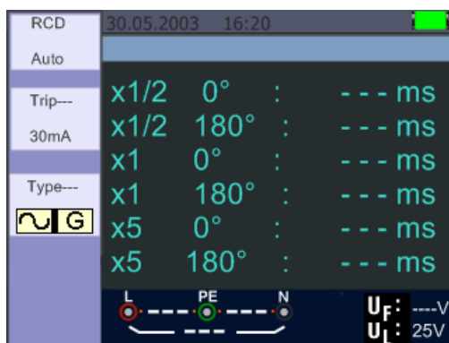
RCD – Pantalla en Standby
