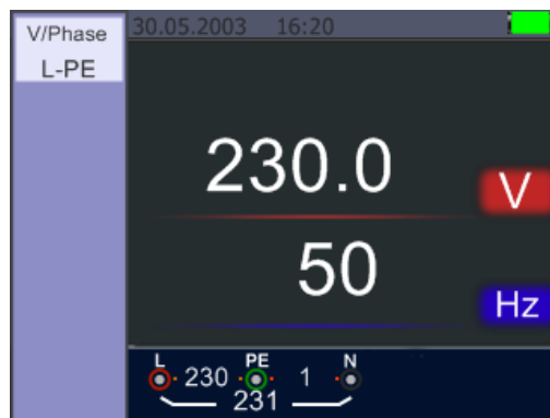
Pantalla en medición de tensión y frecuencia
