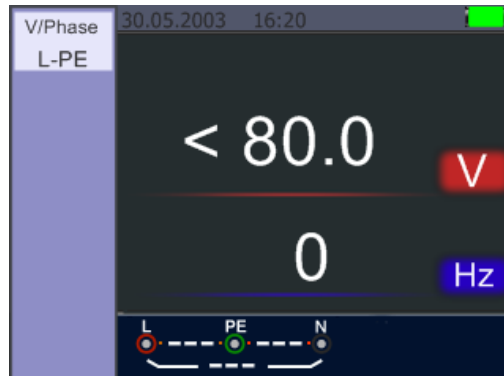
Pantalla de Standby para tensión y frecuencias
