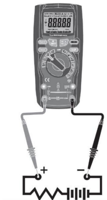
1. Tournez le sélecteur de fonction sur la position  $\mu\text{A}$ , mA ou 10A en fonction du courant à mesurer.
