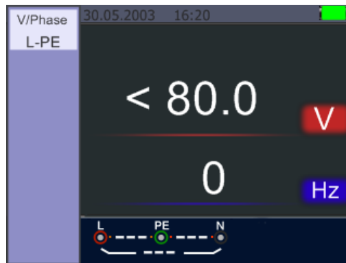
Visualizzazione in standby della misura di tensione (< 80V)
