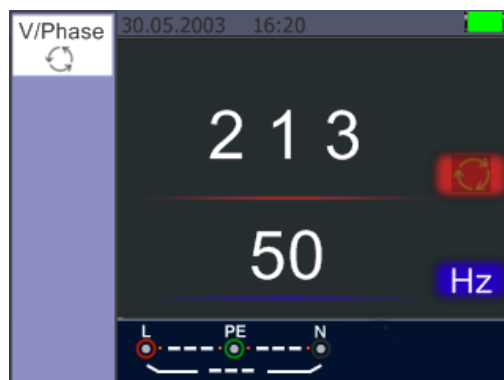
Due fasi invertite (campo rotante in senso antiorario)
